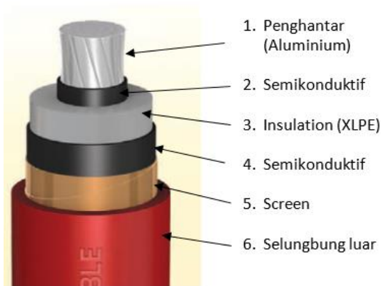
Gambar 2.5. Kabel tanah berinti tunggal Gambar 2.5. yaitu kabel tanah jenis NA2XSY 1x150 cm/25 12/20 ( 24 ) kV menyatakan suatu kabel berinti tunggal, untuk tegangan nominal 12/20 kV, berisolasi XLPE, berpenghantar aluminium dengan luas penampang 150 mm 2 , lapisan tembaga pada bagian luar susunan inti dengan luas penampang 25 mm 2 , dengan selubung PVC. Kabel ini digunakan dalam penelitian ini yang sudah terpasang pada transformator 1 150/20 kV di GIS Gandaria.
